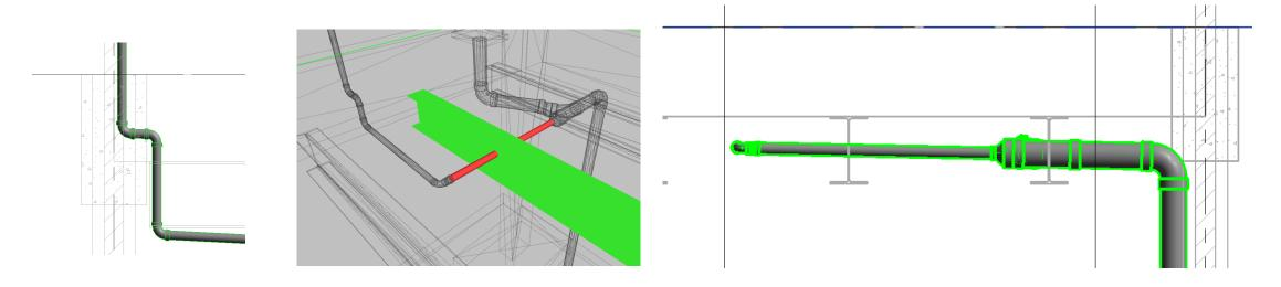
este analisis de deteccion de colisiones es una de la mayores razones para utilizar modelos BIM. el programa de computo detecta el choque entre un tubo y la estructura antes de llegar al sitio de construccion, este error es mas barato de reparar si se detecta temprano.
